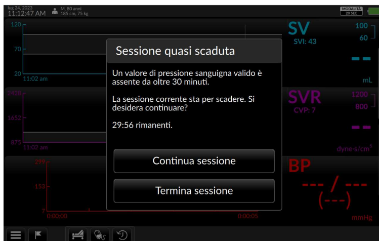
Fig. 5-130. Avviso di mancato rilevamento del segnale BP
