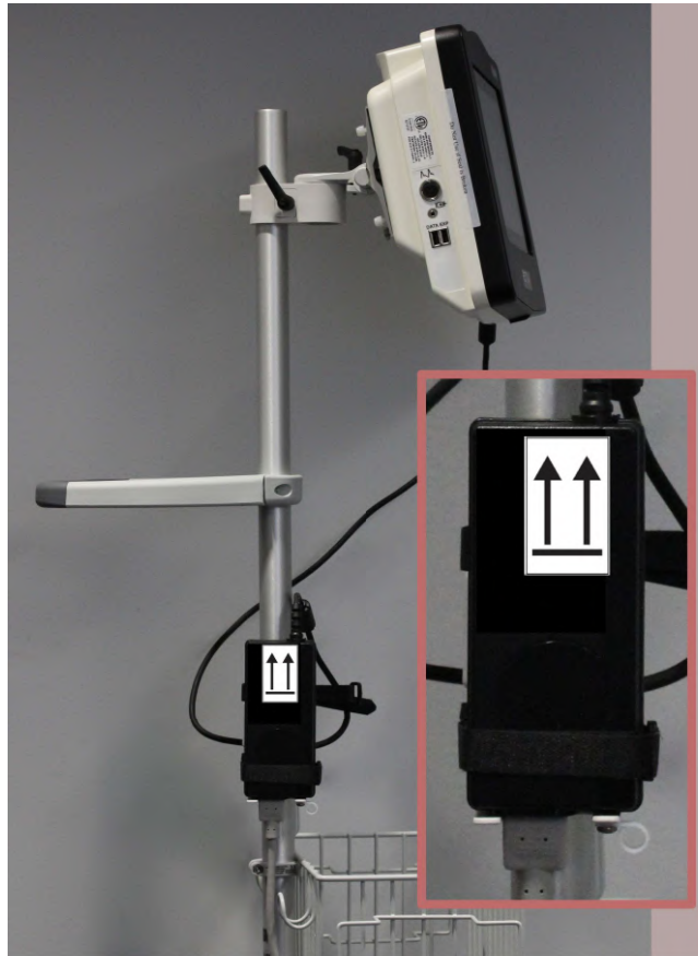
Abb. 1-2: Netzteil korrekt montiert, Pfeile zeigen nach oben
