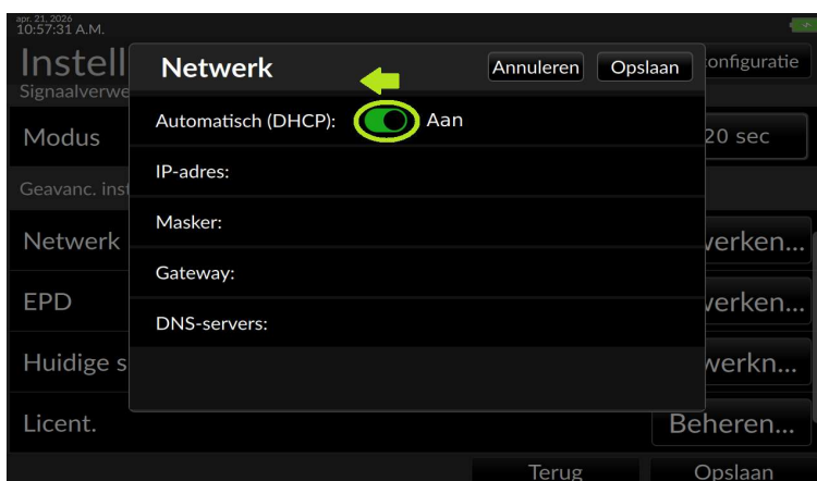
Afb. 4-18: Tik op de schuifknop om DHCP uit te schakelen
