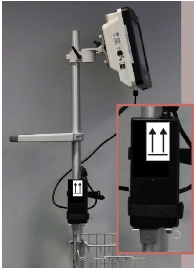
Fig. 1-2: Fonte de alimentação montada corretamente, com as setas apontando para cima
